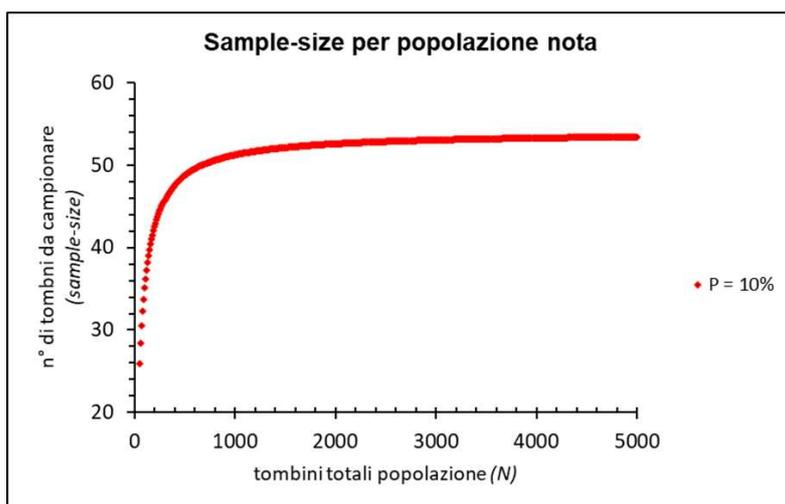
**Figura 2:** la curva in figura indica come varia la dimensione del campione, ovvero il diverso numero di tombini da monitorare in base al numero di tombini presenti in un Comune. Tale insieme di punti è stato definito adattando la formula della sample-size considerando una positività limite del 10%.
